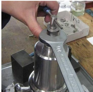
Abb.2 Druckeinstellung des Sicherheitsventils
