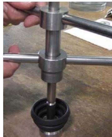
Abb.7 Montage des Elmoster Faltenbalg
